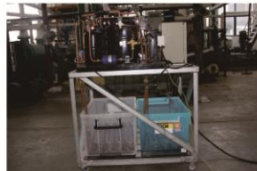
*第一代余热回收装置
